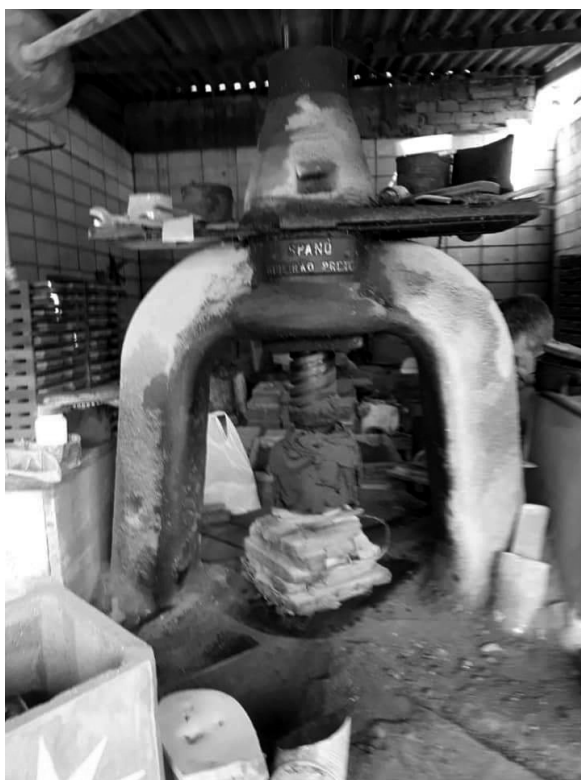
Prensas onde eram fabricados os ladrilhos hidráulicos
